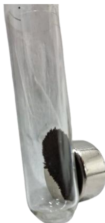
Figura 1 – Imagem do nanocompósito CA-Fe 3 O 4 obtido pelo método de coprecipitação in situ modificado
