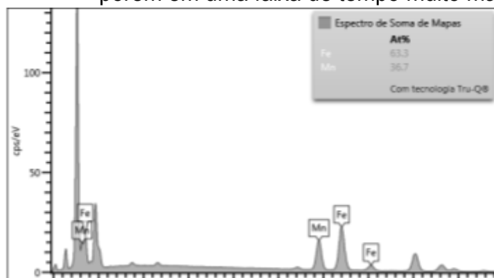
Figura 1. Espectro de EDS para amostra de densidade de corrente 50 \text{mA}/\text{cm}^2 .
