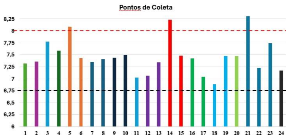
Imagem 2: Média do pH do material (etanol combustível) coletado em postos de combustíveis (colunas com a mesma cor indicam os mesmos postos em dias diferentes), linha pontilhada preta indica o ponto de calibração do eletrodo com o CMR, linha pontilhada vermelha indica o limite máximo do pH permitido pela legislação brasileira (pH 6 – 8).
