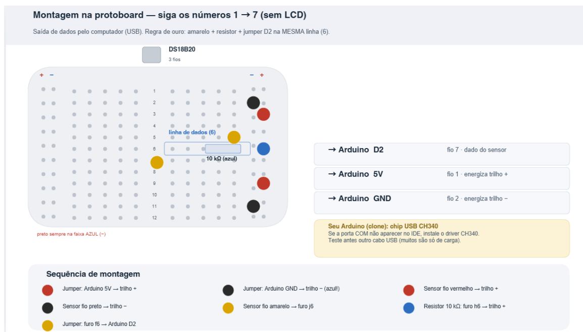
Figura 1. Esquema de montagem do calorímetro: ligação do sensor DS18B20 ao Arduino UNO por uma protoboard , com o resistor de 10 kΩ ( pull-up ) e o jumper até o pino D2 (sequência 1 → 7).
