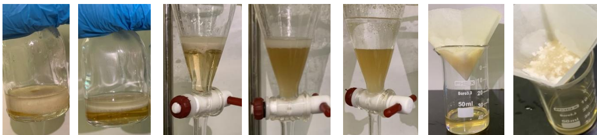
Figura 3. Registros fotográficos da ELL da APS contendo concentrações de surfactante \geq 44 \text{ mg.L}^{-1} : (a) amostra coletada da emulsão inicial pós centrifugação; (b) emulsão após aquecimento a 40^\circ\text{C} ; (c) emulsão após primeira extração; (d) emulsão após a adição de 1 \text{ mL} de \text{C}_3\text{H}_8\text{O} ; (e) emulsão pós remoção do \text{C}_3\text{H}_8\text{O} com água DI; (f) filtração da fase orgânica em sulfato de sódio anidro; e (g) filtro após a etapa de secagem com o sal.
