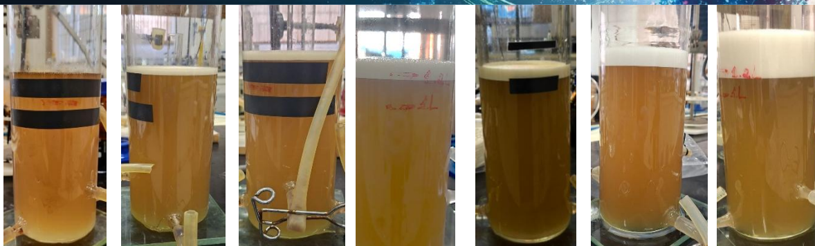
Figura 1. Registros fotográficos da APS inicial contendo: (a) 0 mg.L -1 ; (b) 11 mg.L -1 ; (c) 22 mg.L -1 ; (d) 44 mg.L -1 ; (e) 87 mg.L -1 ; (f) 131 mg.L -1 ; e (g) 174 mg.L -1 de surfactante zwitteriônico.
