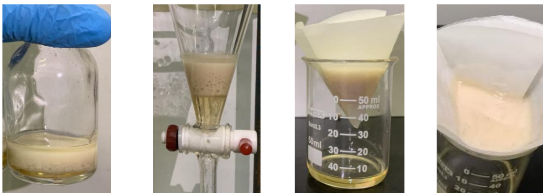
Figura 2. Registros fotográficos da ELL da APS contendo concentrações de surfactante \geq 44 mg.L -1 : (a) amostra coletada da emulsão inicial pós centrifugação; (b) emulsão após primeira extração; (c) filtração da fase orgânica em sulfato de sódio anidro; e (d) filtro após a etapa de secagem com o sal.
