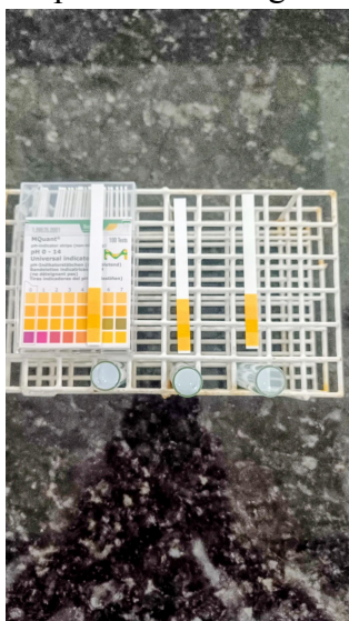
Figura 10. Medição do potencial hidrogeniônico da nanoemulsão
