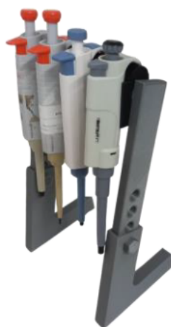
Figura 4 – Suporte para micropipetas fabricado em PLA, com pontos de apoio adaptados à curvatura dos instrumentos e estabilidade para uso na rotina laboratorial.
