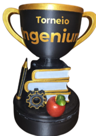
Figura 8 – Troféu de aproximadamente 22 cm de altura, fabricado em três componentes impressos separadamente em PLA, unidos por colagem e submetidos a acabamento por pintura.
