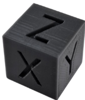
Figura 3 – Cubo de calibração XYZ, com dimensões nominais de 20 × 20 × 20 mm, utilizado para avaliação da qualidade de impressão nos eixos X, Y e Z.
