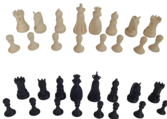
Figura 5 – Conjunto de peças de xadrez impressas em PLA, utilizado para avaliar a reprodução de geometrias variadas e complexas.
