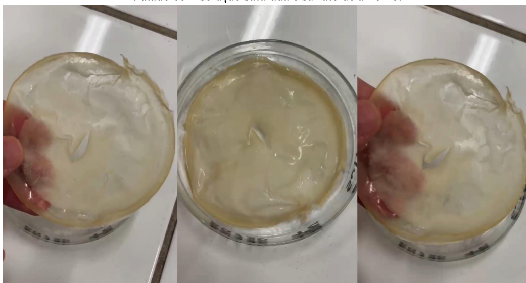
Figura 11 - Filme de razão 80/20 (gelatina/quitosana) com 5% (m/m) de TG em relação a massa seca de proteína tratado com solução saturada e sulfato de amônio.
