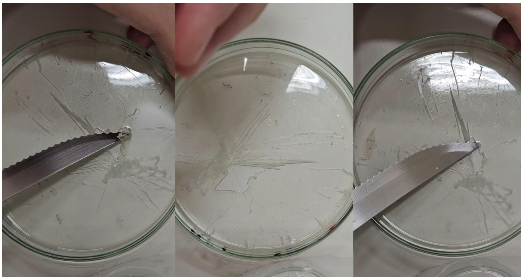
Figura 4 - Filme de gelatina 10% (m/v), com 5% (m/m) de TG em relação a massa seca de proteína, tratado com etanol absoluto.
