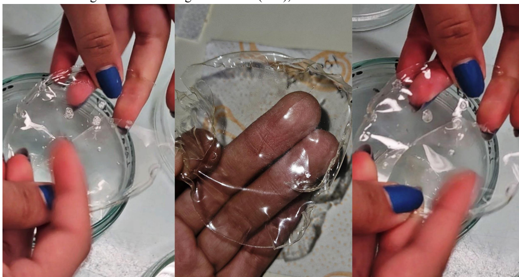
Figura 5 - Filme de gelatina 10% (m/v), tratado com etanol absoluto.
