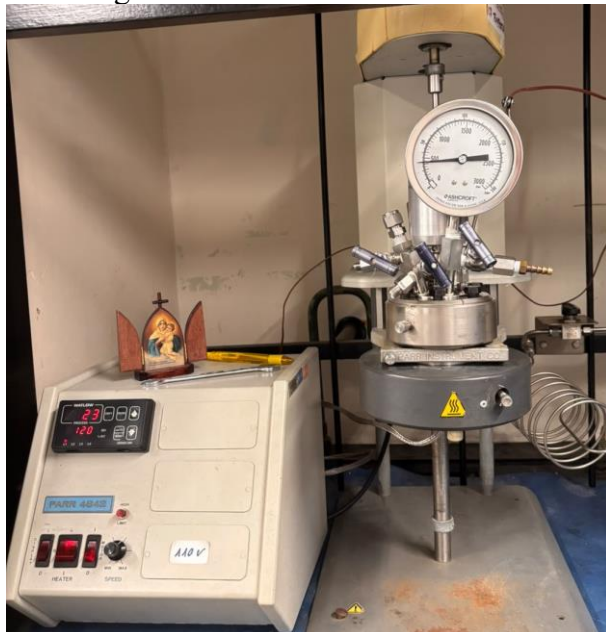
Figura 1: sistema do reator PARR.
