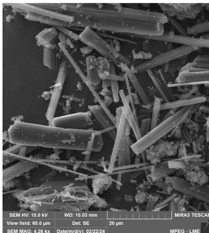
Fig. 5: Fotomicrografia de MEV de sodalita obtida de rejeitos de lavagem de bauxita da Amazonia.
