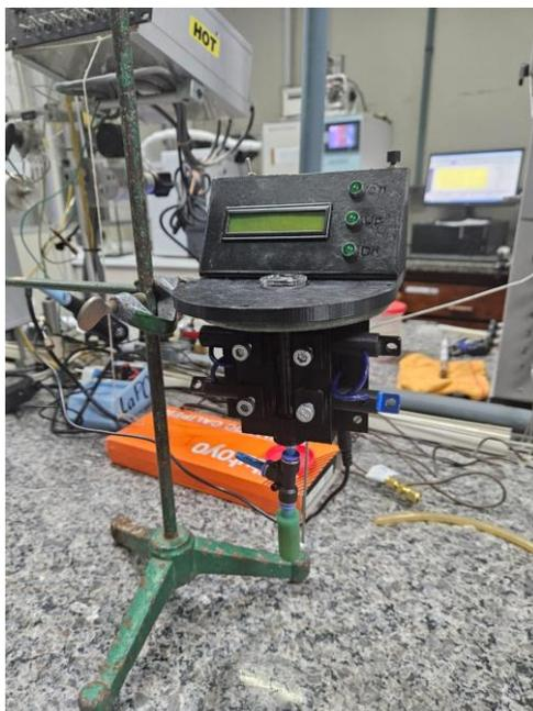
**Figura 2.** Bolhômetro digital montado.
