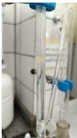
Figura 2. Obtenção de óleos essenciais por hidrodestilação utilizando aparelho de Clevenger.
