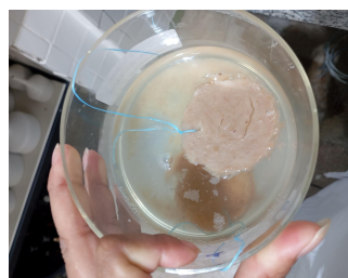
Figura 3 - Disposição dos recipientes e sistema de acondicionamento das amostras de biofilmes para o teste de degradação em solo e amostras submetidas em meio aquoso.
