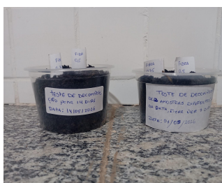
Figura 3 - Disposição dos recipientes e sistema de acondicionamento das amostras de biofilmes para o teste de degradação em solo e amostras submetidas em meio aquoso.
