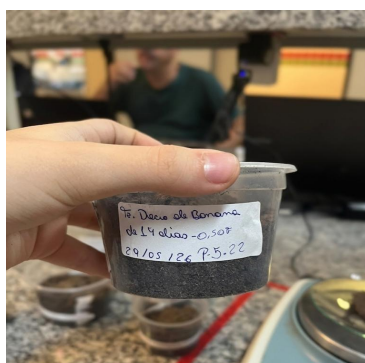
Figura 2 – Ensaio de biodegradação em solo dos biofilmes produzidos a partir da farinha de banana-da-terra ( Musa spp. ).
