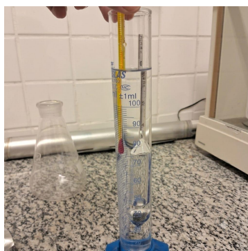
Figura 4 – Determinação do teor alcoólico do bioetanol produzido a partir da casca de tangerina utilizando álcoolmetro.
