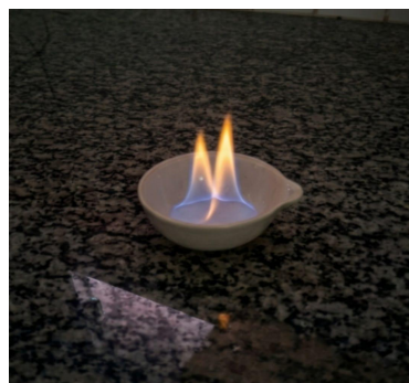
Figura 5 – Ensaio de combustão do bioetanol obtido a partir da casca de tangerina.
