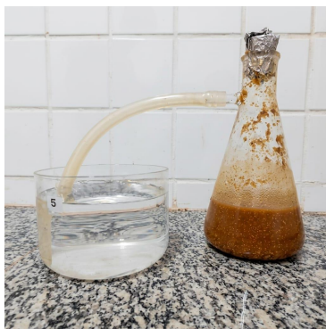
Figura 2 – Processo de fermentação alcoólica do mosto obtido a partir da casca de tangerina utilizando Saccharomyces cerevisiae .
