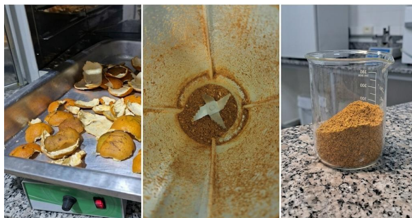
Figura 1 – Etapas de preparo da biomassa da casca de tangerina: (A) secagem em estufa; (B) trituração do material seco; (C) biomassa triturada e peneirada em forma de pó.
