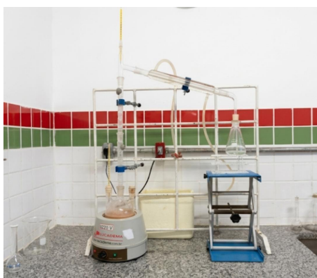
Figura 3 – Sistema de destilação fracionada utilizado na obtenção do bioetanol a partir da casca de tangerina ( Citrus reticulata Blanco).
