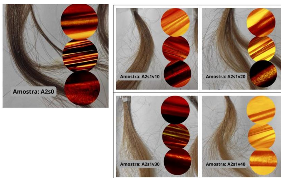
Figura 3: Registro fotográfico macroscópico e micrografias de Microscopia Óptica de Luz Polarizada (MOLP) das fibras capilares da série A2 no estado inicial (A2s0) e após
