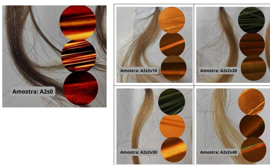
Figura 4: Registro fotográfico e micrografias de Microscopia Óptica de Luz Polarizada (MOLP) das fibras capilares da série A2 no estado inicial (A2s0) e após descoloração por 60 minutos (tempo S2) utilizando H_2O_2 em diferentes volumagens: 10 volumes (A2s2v10), 20 volumes (A2s2v20), 30 volumes (A2s2v30) e 40 volumes (A2s2v40). Os encartes microscópicos ilustram a erosão acentuada do relevo cuticular e a redução generalizada da birrefringência cortical induzida pelo estresse oxidativo prolongado.]
