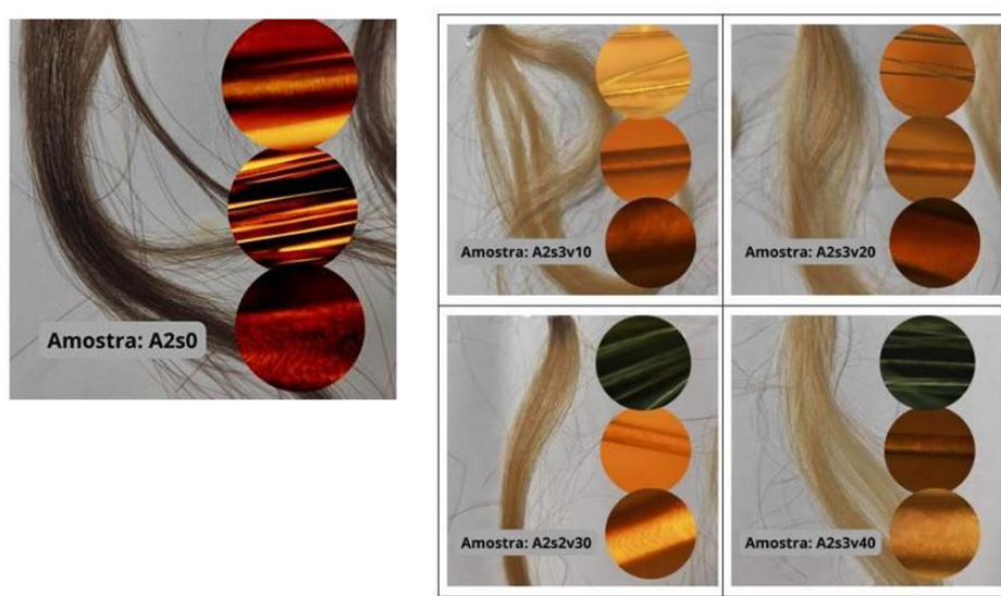
Figura 5: Registro fotográfico macroscópico e micrografias obtidas por Microscopia Óptica de Luz Polarizada (MOLP) das fibras capilares da série A2 no estado inicial (A2s0) e após descoloração severa por 120 minutos (tempo S3) sob diferentes concentrações oxidantes: 10 volumes (A2s3v10), 20 volumes (A2s3v20), 30 volumes (A2s3v30) e 40 volumes (A2s3v40). Os encartes microscópicos evidenciam a desestruturação crítica da fibra capilar e a supressão progressiva da birrefringência cortical, culminando na perda total da anisotropia óptica e degradação massiva na condição de 40 volumes.
