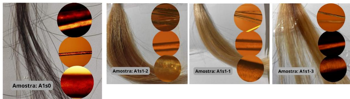
Figura 2: Registro fotográfico e micrografias obtidas por Microscopia Óptica de Luz Polarizada (MOLP) das fibras capilares da série A1 no estado inicial (A1s0) e após 30 min de descoloração com H_2O_2 a 20 volumes: sob tecnologia Fibre Plex (A1s1-1), com Hacker Protection (A1s1-2) e sem sistema de proteção (A1s1-3). Os encartes microscópicos ilustram o perfil de integridade da camada cuticular e o grau de birrefringência/orientação macromolecular dos microfilamentos de queratina no córtex para cada condição avaliada.
