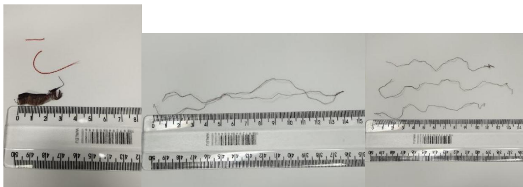
Figura 1. Amostras de fibras têxteis provenientes da pala e suas dimensões aproximadas.
