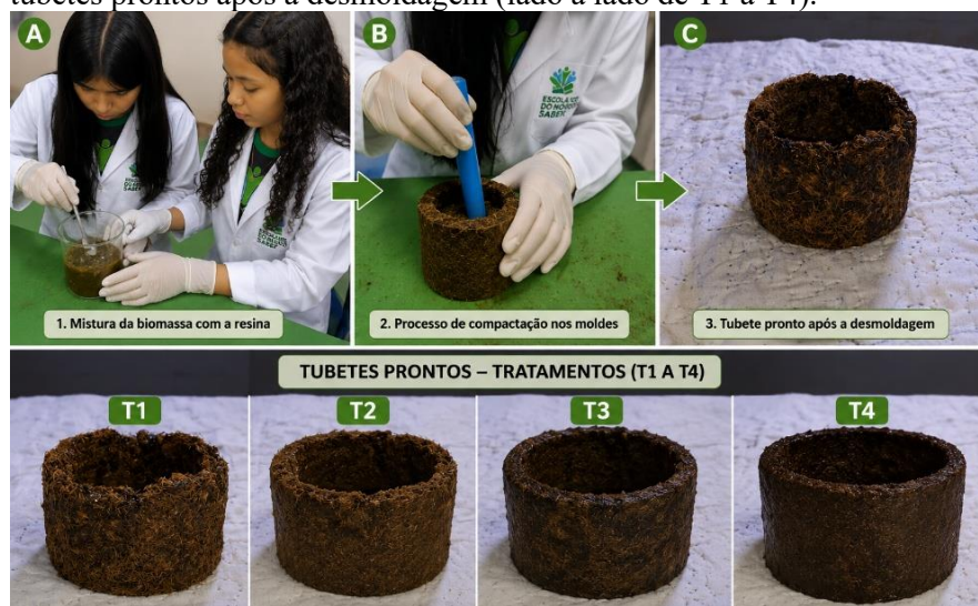
Figura 4 - (a) mistura da biomassa com a resina, (b) processo de compactação nos moldes e (c) tubetes prontos após a desmoldagem (lado a lado de T1 a T4).
