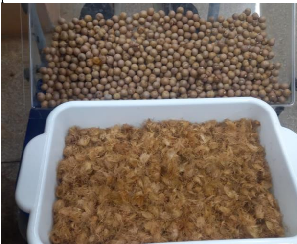
Figura 2 - Processo de moagem e peneiramento dos caroços de açaí, mostrando a textura final do pó/fibra obtido.
