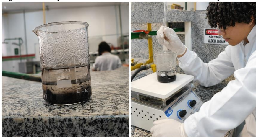
Figura 2 - Precipitado escuro obtido durante a síntese de nanopartículas de magnetita.
