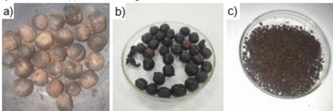
Figura 1 - Etapas da produção do carvão a partir do caroço de açaí: (a) caroço in natura, (b) material após carbonizar e (c) carvão ativado granulado.
