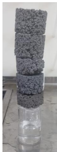
Figura 2: Torre de filtros de concreto poroso antes da vedação lateral com silicone
