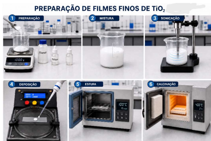
Figura 2 – Passo a passo da metodologia Spin Coating
