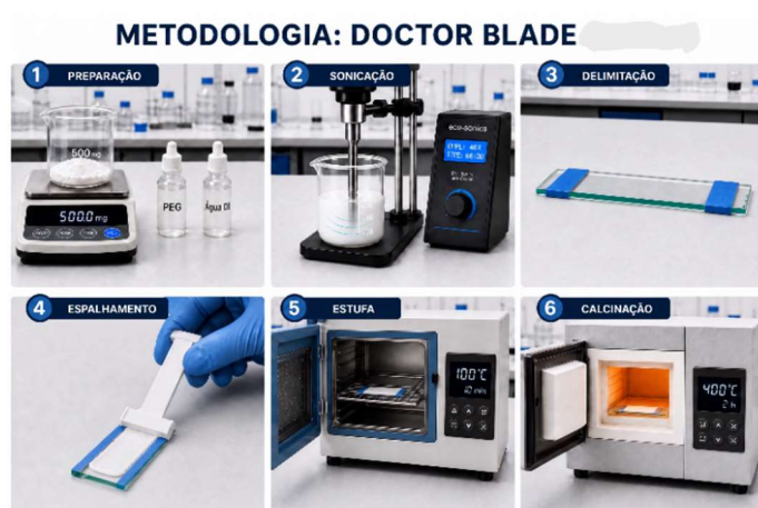
Figura 1 – Passo a passo da metodologia Doctor Blade
