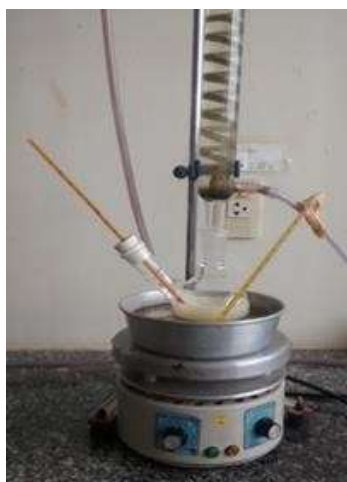
Figura 2 – Etapa de tratamento da oleína por esterificação acida
