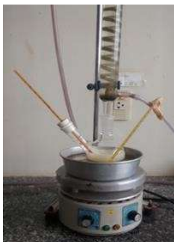
Figura 2 – Etapa de tratamento da oleína por esterificação acida
