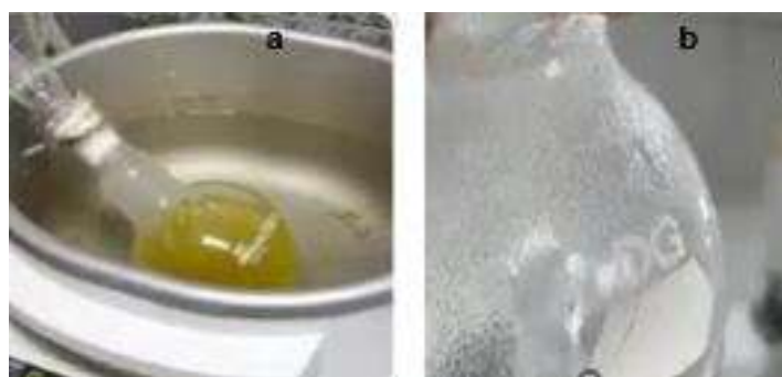
Figura 8 – Processo de desumidificação da oleína esterificada
