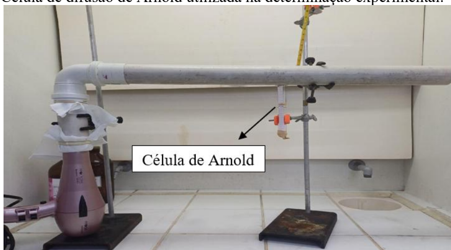
Figura 1 - Célula de difusão de Arnold utilizada na determinação experimental.
