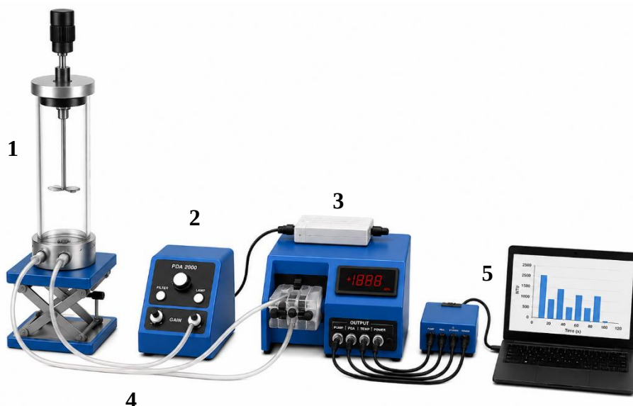
Figura 2. Representação esquemática do sistema de análise por dispersão fotométrica, composto por: (1) coluna de floculação, (2) bomba peristáltica, (3) analisador fotométrico de dispersão, (4) linha de recirculação da APS e (5) sistema de aquisição de dados.
