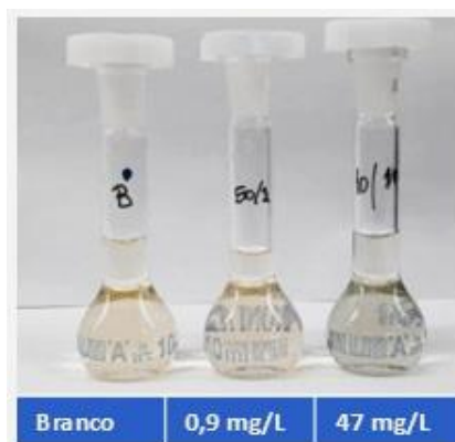
Figura 1: reação de azul de molibdênio em salmoura hipersalina nas concentrações de fosfato de 0, 0,95 e 47 mg.L -1 de PO 4 3- .
