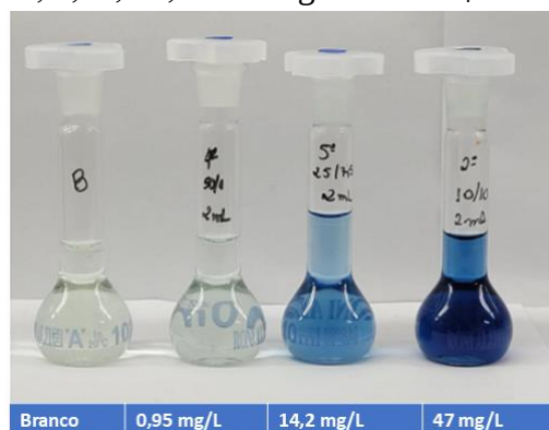
Figura 2: reação de azul de molibdênio em presença de 292.250 ppm de NaCl nas concentrações de fosfato de 0, 0,95, 14,2 e 47 mg.L -1 de PO 4 3- sem interferência da matriz.
