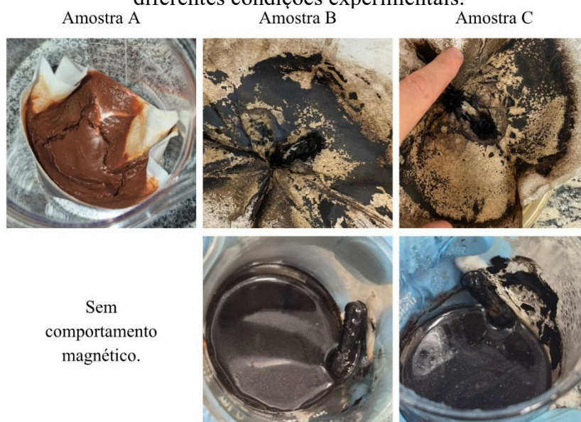
Figura 2. Aspecto visual e comportamento magnético das amostras sintetizadas sob diferentes condições experimentais.
