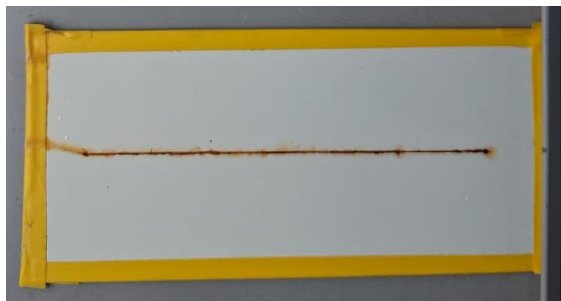
Figura 3: Aspecto visual da placa revestida com ZnO sintetizado após 1 semana de exposição ao ensaio de Salt Spray.
