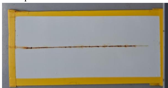
Figura 2: Aspecto visual da placa revestida com ZnO comercial após 1 semana de exposição ao ensaio de Salt Spray.
