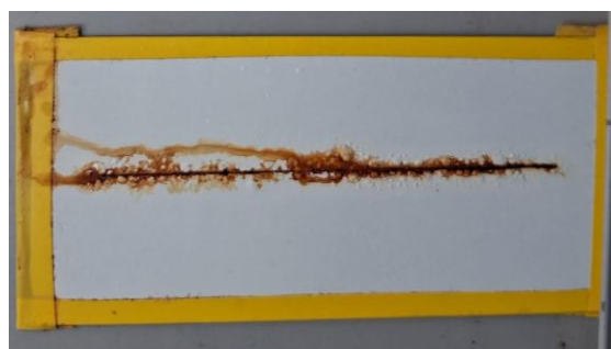
Figura 4: Aspecto visual da placa revestida sem carga após 1 semana de exposição ao ensaio de Salt Spray.
