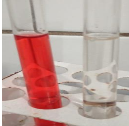
Figura 2: Comparação entre amostras do efluente sintético (solução 1,5 g/L corante vermelho Nº 15 Tupy, em meio aquoso contendo NaCl a 1 g/L) antes e depois do tratamento. Tempo de 15 min.
