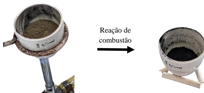
Fig. 2 Transformação da planta após processo de combustão.
