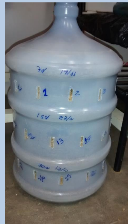
Modelo para exposição das placas de aço em solo coletado
