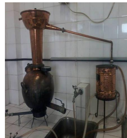
Figura 6 – Alambique de cobre utilizado na destilação.
