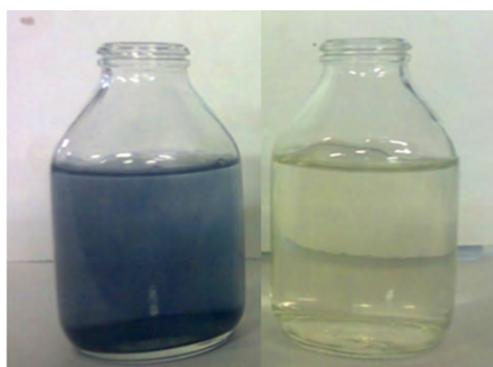
**Figura 5: Comparação entre o efluente bruto e após tratamento via Fenton**
