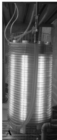
Figura 2. A. Sistema de propulsão airlift de tipo convencional
