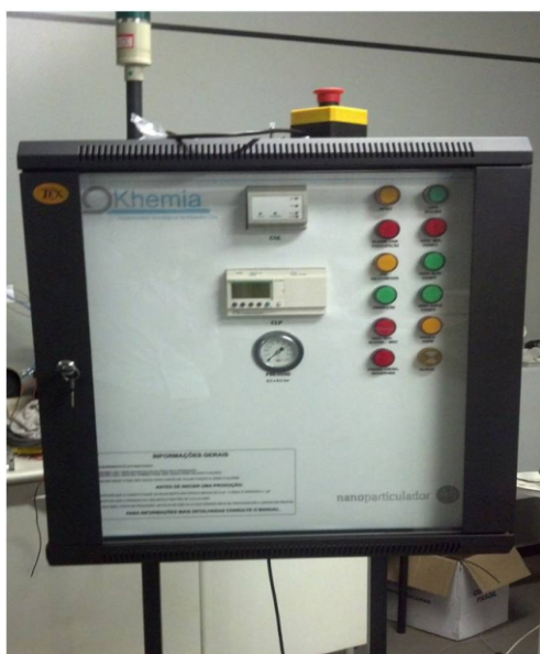
Figura 3: Equipamento Khemia para a obtenção das nanopartículas de prata.
