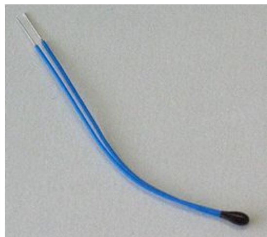
Alguns tipos de sensores mais comuns: termômetro de mercúrio (à esquerda) e termistor, um resistor sensível à temperatura (à direita)
