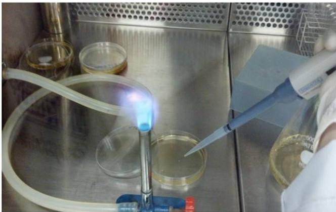
**Figura 5:** Inoculação da Amostra pelo Método Pour Plate.
