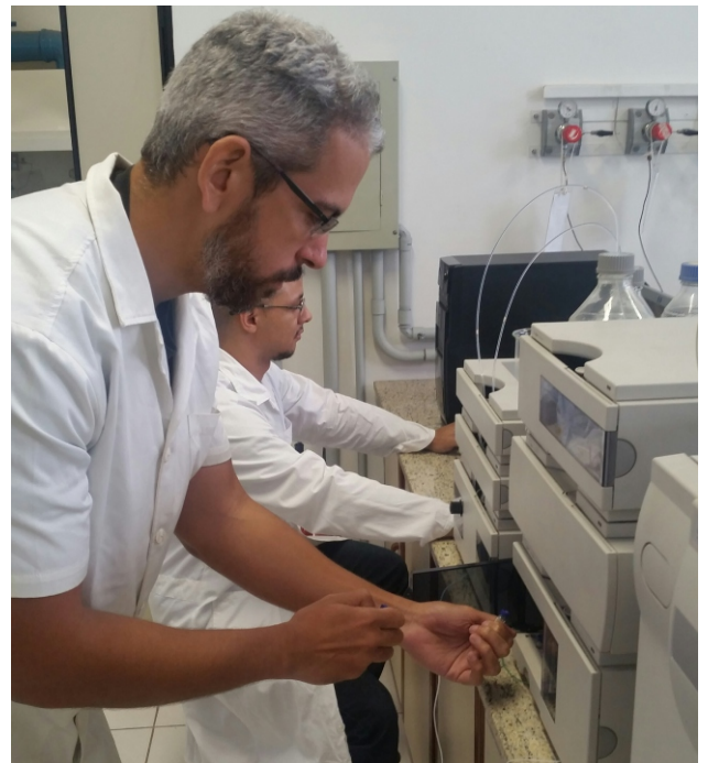
Extração da amostra de formaldeído (acima) e equipamento de cromatografia líquida de alta resolução para determinação de formaldeído (à direita)
