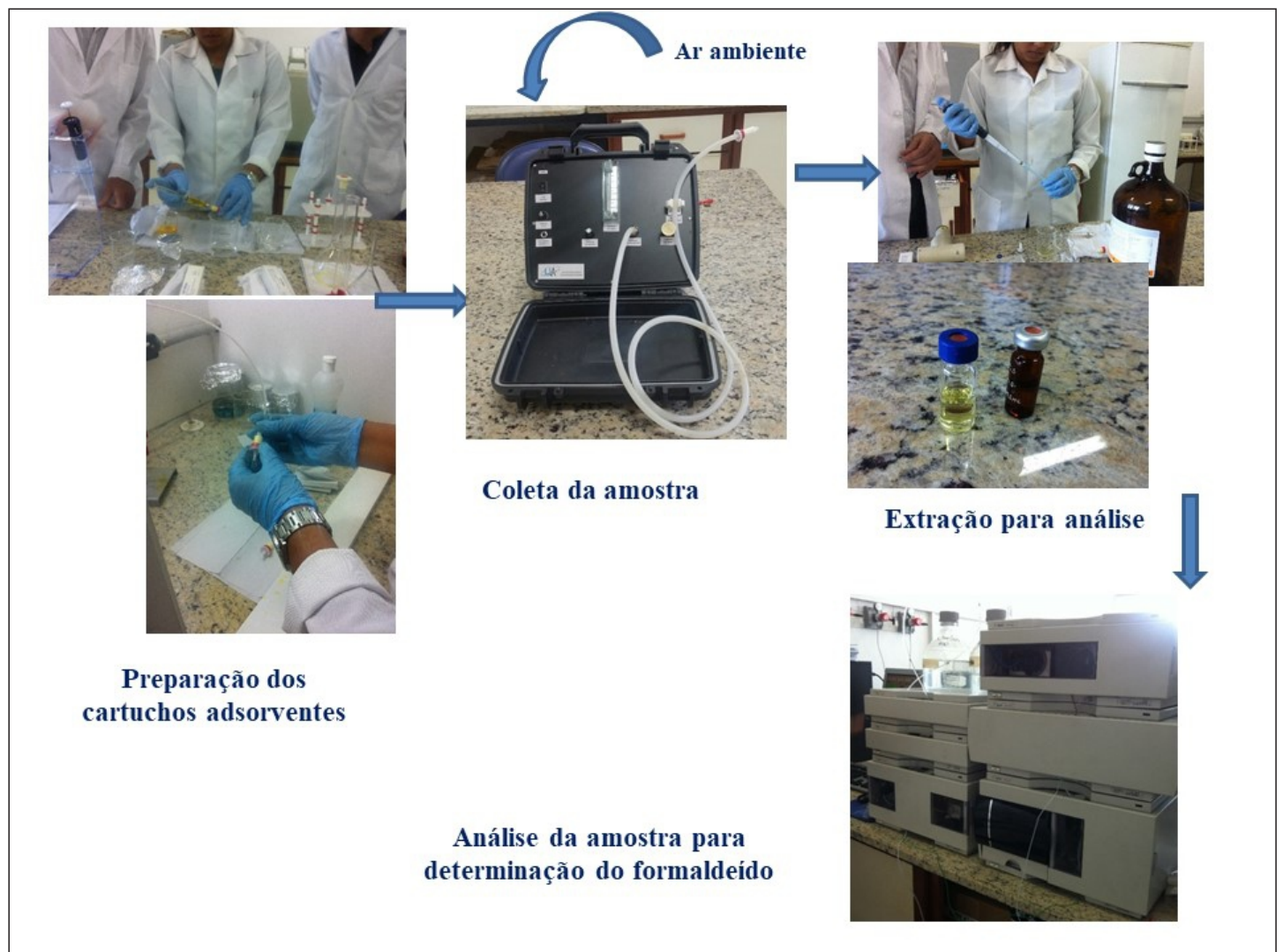
Esquema simplificado do método para determinação de formaldeído
