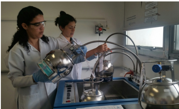
Limpeza dos canisters para coleta de COVs
