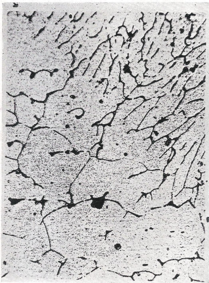
Fig. 1—A linha diagonal, assinalada pelas setas, divide o campo nitidamente em duas zonas: uma é a do metal de solda; a outra, a extensa zona alterada pelo calor. Os grãos largos da última zona, abaixo da diagonal, são notórios. (x 300)
