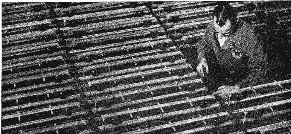
O Precipitron, limpador eletrostático do ar das habitações, está prestando variadíssimos serviços em muitas aplicações industriais. Elimina os fumos e traços de óleo, do ar que cerca as máquinas ferramentas de alta velocidade; limpa o ar dos altos fornos; mantém limpos os enrolamentos das máquinas elétricas giratórias, pela depuração do ar da ventilação forçada. E estas são apenas algumas das variadas tarefas de que vai dando conta
