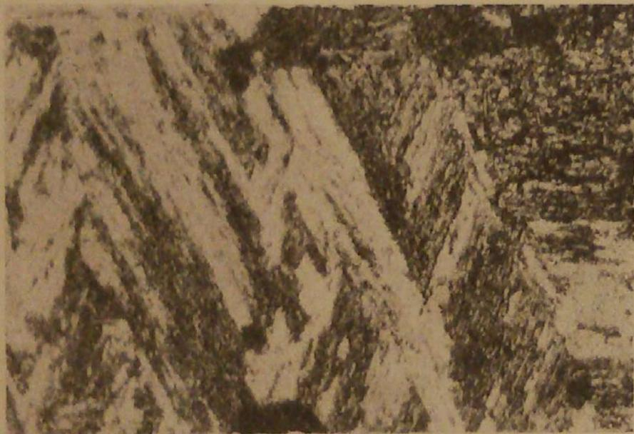
Microfotografia interessando a borda de ruptura do tubo n. 1, aproximadamente a meia distância da extensão total rompida. Estrutura martensítica — Ataque: nital.
