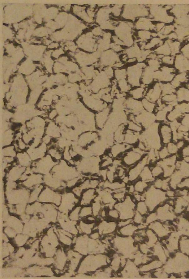
Aspectos estruturais colhidos nas extremidades dos tubos examinados: ferrita e perlita. Da esquerda para a direita e de cima para baixo, tubos 1, 2, 3 e 4, respectivamente. Nota-se ainda no tubo n. 1 franco aspecto de widmanstaetten e no n. 4, granulação de ferrita apreciavelmente menor que nos outros —
