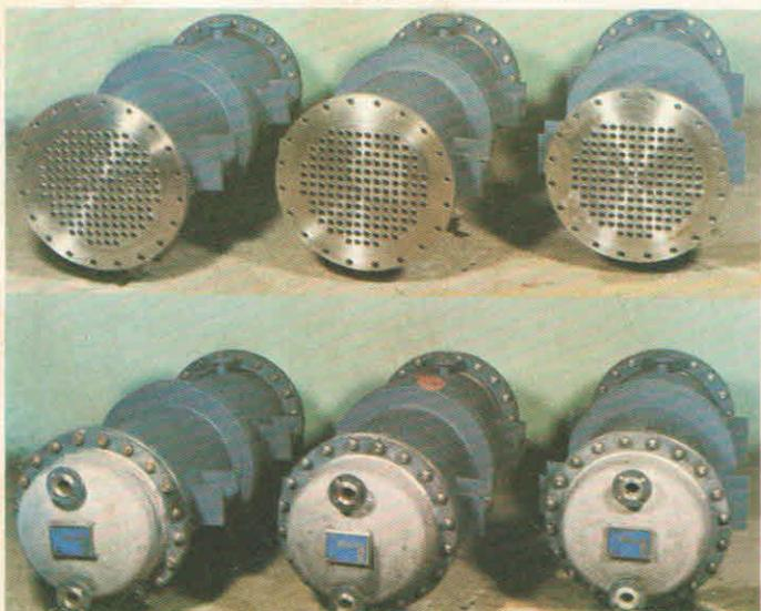
Condensador para hidrocarbonos, área 20 m<sup>2</sup>, 6/6 atm.
