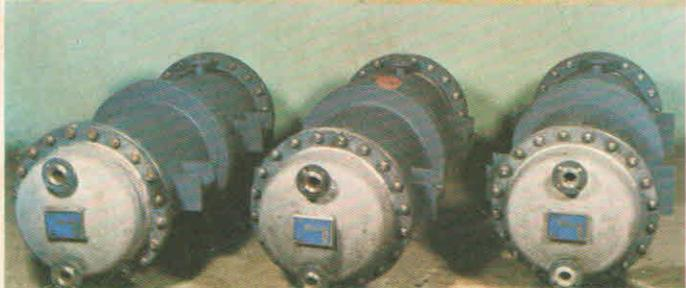
Condensador para hidrocarbonos, área 20 m<sup>2</sup>, 6/6 atm.
