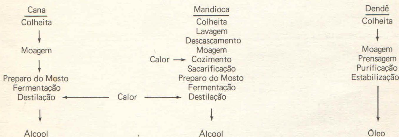
Os processos de elaboração do álcool etílico caracterizam-se pela necessidade de utilização de calor e pelos grandes volumes envolvidos, já que o rendimento de produto final (etanol) é da ordem de 10%, com relação ao mosto fermentado. A produção de 16 bilhões de litros de etanol exigiria o manuseio de 160 bilhões de litros de mosto. Tais problemas não existem no caso do óleo.
