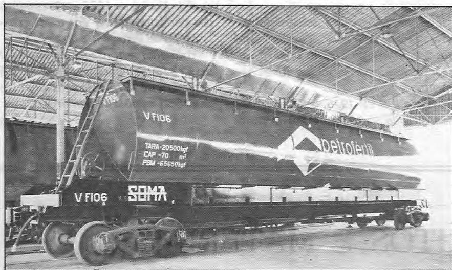
A Goodyear do Brasil revestiu com borracha oito vagões da Soma Equipamentos Industriais S.A., de Sumaré, São Paulo, que foram adquiridos pela Petrofertil para o transporte de fertilizantes. Trata-se do primeiro tipo de vagão especialmente fabricado para transportar fertilizantes no país.
