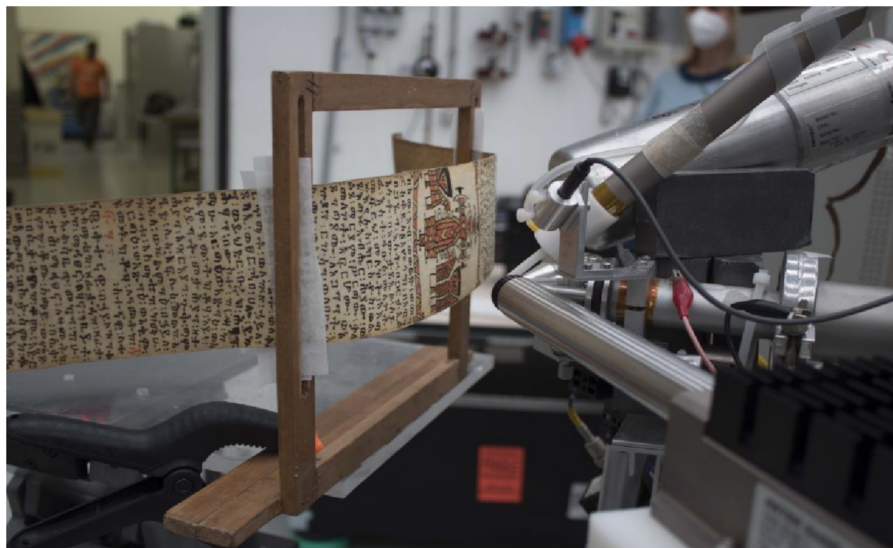
Figura 2: Pergaminho durante a medição por IBA na linha de feixe externo do INFN LABEC.
